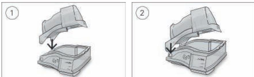
1. Insérez un côté du couvercle dans le trou de pivot de la base.
