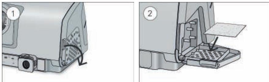
1. Ouvrez le couvercle du filtre à air et retirez l'ancien filtre à air.
