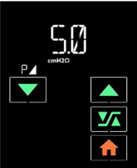
**Pression de confort** : niveau de pression produit au départ de la rampe
